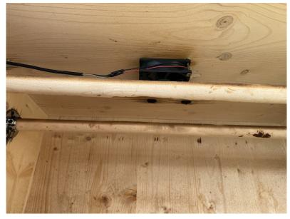
Der Ventilator dient sowohl zur Umwälzung als auch zur Entfernung des Rauches aus der Kammer.
